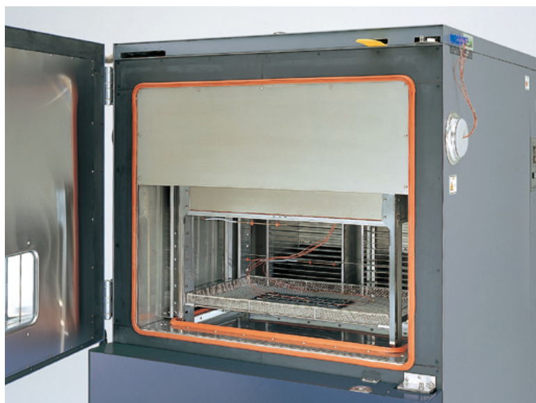
TSD-101-W 試料温度測定 (試料温度入力 標準装備 : 2点 オプション : 3点)
